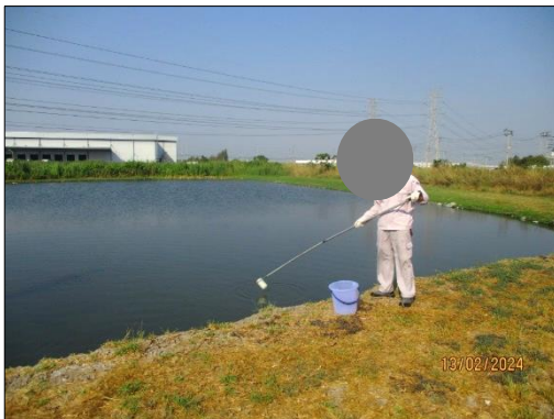
ระบบบำบัดน้ำเสียส่วนกลางทางชีวภาพ บริเวณบ่อพักน้ำทิ้งสุดท้าย (Holding & Effluent Pond)
